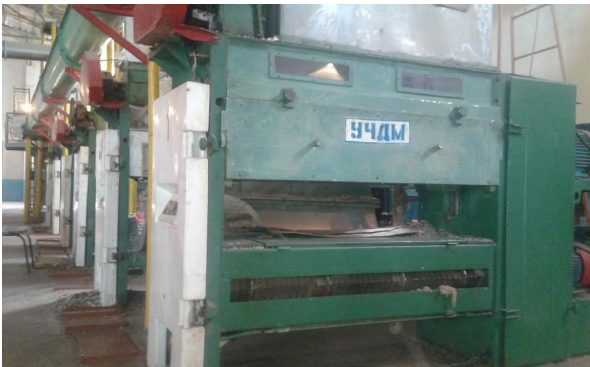
1-расм. Такомиллаштирилган арра-металл чўткали барабанлар ўрнатилган УЧДМ делинтерини туксизлантирилган уруғлик чигит тайёрлаш сеҳига ўрнатилган ва иш ҳолатига келтирилгандаги умумий кўриниши
