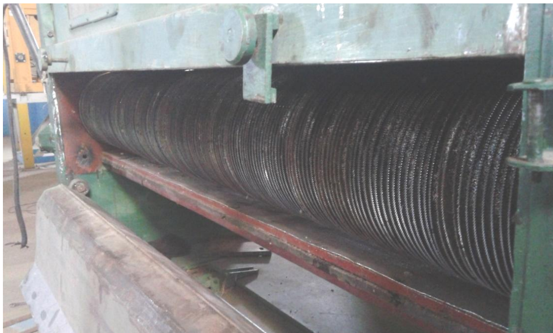
2-расм. Такомиллаштирилган арра-металл чўткали барабанлар ўрнатилган УЧДМ делинтерини юқори ишчи камерасига ўрнатилган натурал ўлчамдаги арра-металл чўткали барабанларни иш ҳолатидаги кўриниши
