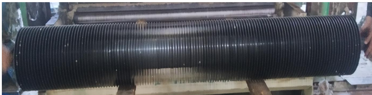
1-rasm. Linter mashinasi arrali silind paketi umumiy ko‘rinishi
