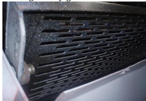
b)-taklif qilinayotgan to'rtli yuzali kolosnik panjara
